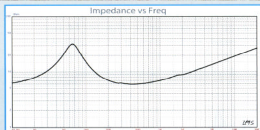
FIGURE 9: Morel EM 428 free-air impedance plot.
